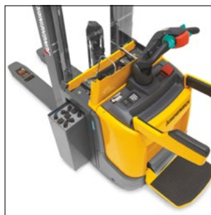
Batteribyte från sidan
