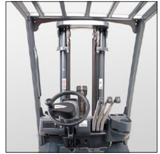
Utmärkt sikt över lasten tack vare siktoptimerad stativkonstruktion.
