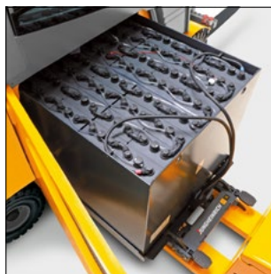
Batteribyte från sidan
